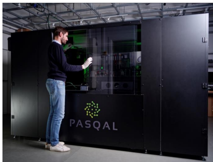
Calculateur quantique Fresnel de Pasqal acquis par GENCI Credits : PASQAL
